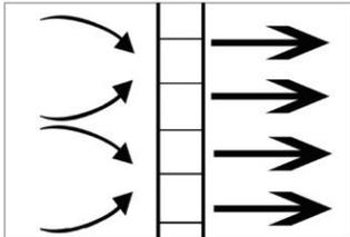
Integrierter Strömungsgleichrichter - keine Einlaufstrecken notwendig
