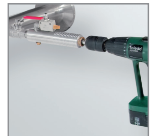
Anbohren unter Druck mit der CS Bohrvorrichtung
