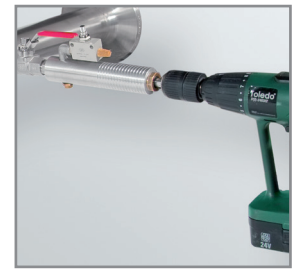
Anbohren unter Druck mit der CS Bohrvorrichtung
